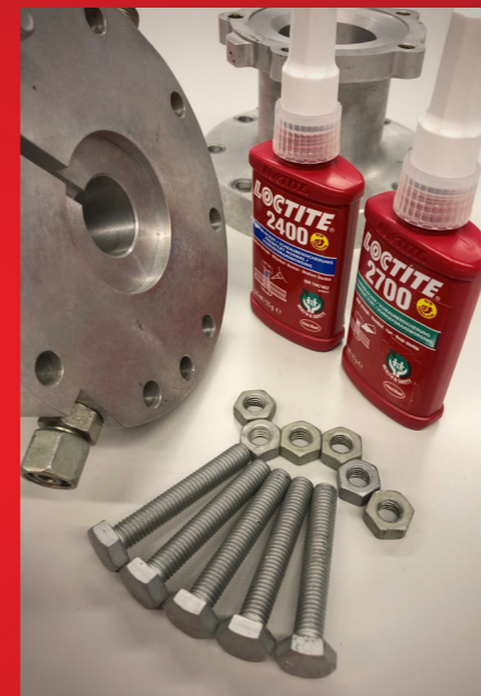
Figuur 8: breekmoment op GEOMET 500A. Uithardingstijden 1-168 uur.
